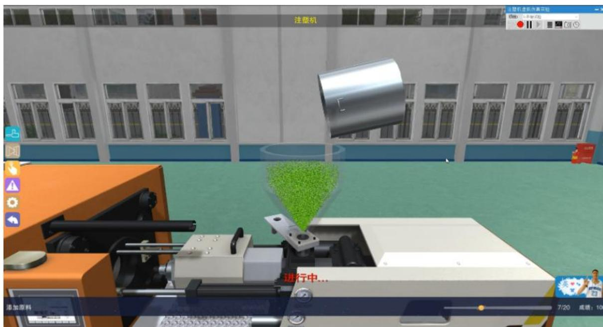
图18 高分子材料注塑成型仿真系统
